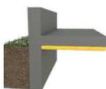
**Ajout d'une isolation en sous-face du plancher bas : 80 mm de polyuréthane en panneaux - R = 3.6 m<sup>2</sup>.K/W - Surface isolée = 109 m<sup>2</sup>**
