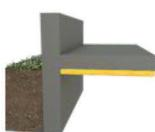
**Ajout d'une isolation en sous-face du plancher bas : 80 mm de polyuréthane en panneaux - R = 3.6 m<sup>2</sup>.K/W - Surface isolée = 109 m<sup>2</sup>**
