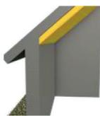
**Remplacement de l'isolation de la toiture par : 310 mm de ouate de cellulose en panneaux + doublage intérieur - R = 8.1 m<sup>2</sup>.K/W - Surface isolée = 110 m<sup>2</sup>**
