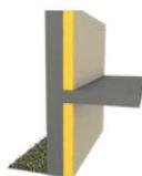
**Ajout d'une isolation thermique par l'intérieur des murs extérieurs : 210 mm de fibre de bois en panneaux + doublage intérieur - R = 5.0 m<sup>2</sup>.K/W - Surface isolée = 136 m<sup>2</sup>**
